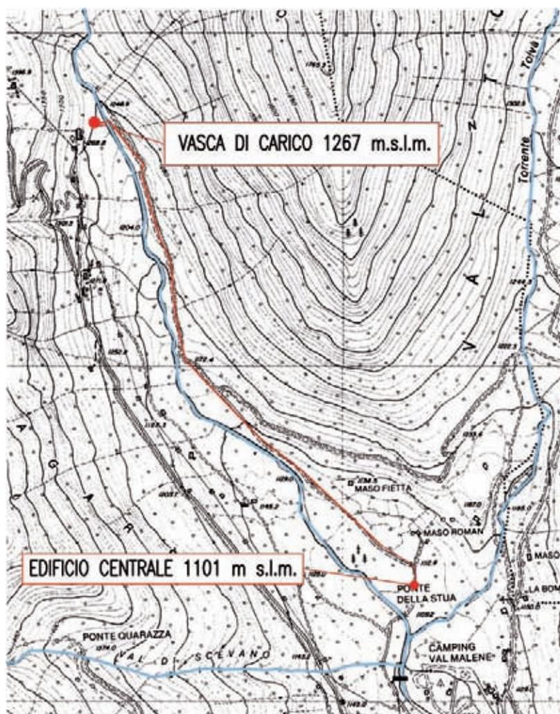
La nuova centrale disporrà di un gruppo Pelton che verrà utilizzato generalmente durante le ore di punta; verrà realizzato ad asse verticale a 4 getti, con potenze massima pari a 1500 kW ed elevati rendimenti (superiori al 80%) per portate variabili da 250 a 1100 l/s.
