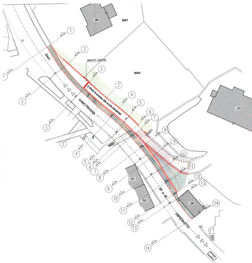
contenimento di elevata altezza, di edifici, della passerella, di sottoservizi di ogni genere e, in particolare alla dimensione ridotta della sede stradale. Si rende quindi necessario il ridimensionamento della piattaforma viabile ed una "traslazione" della strada di accesso alla scuola elementare, al fine di ricavare la superficie minima necessaria per la realizzazione del nuovo marciapiede nel ri-
