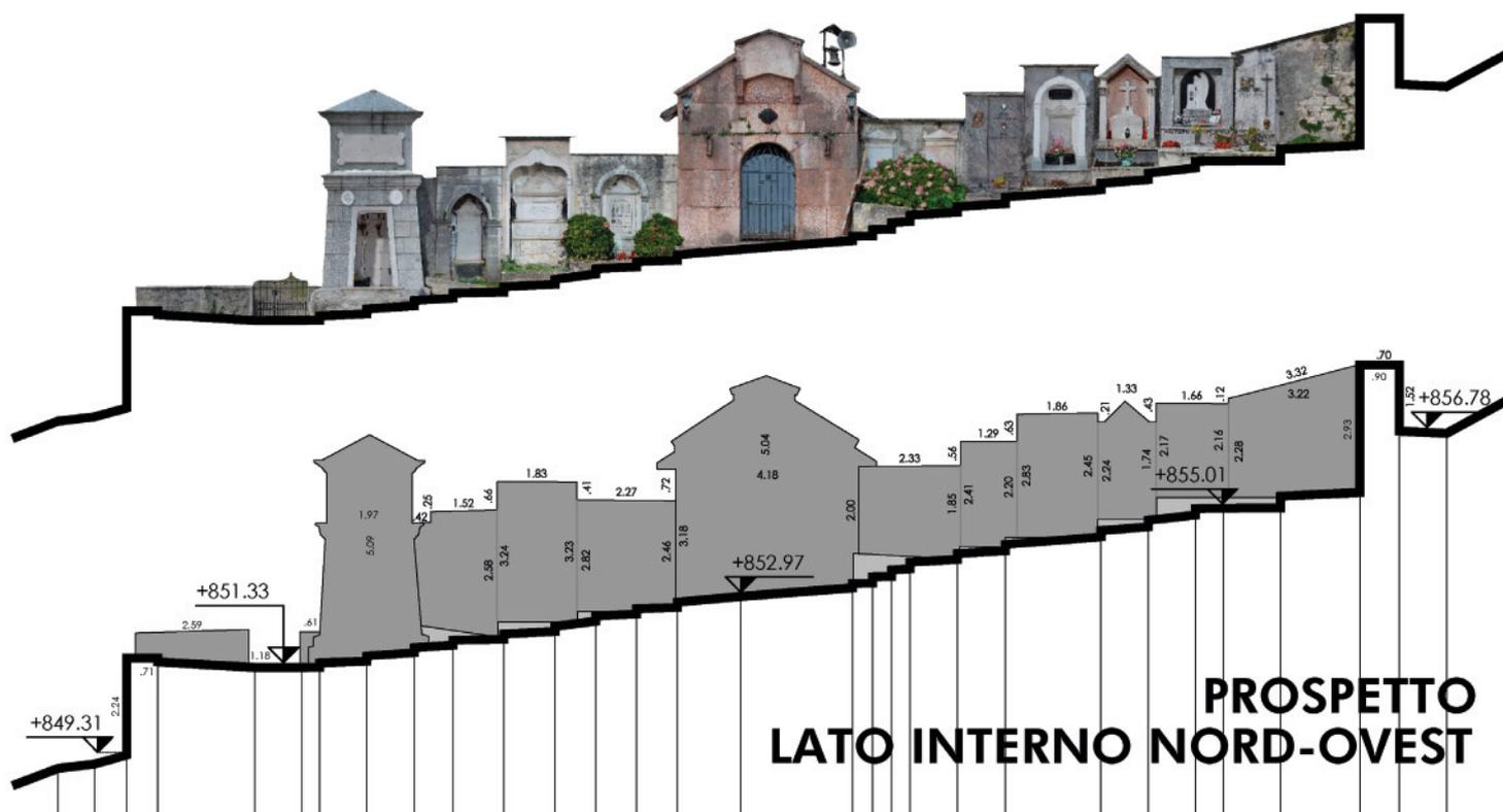
ESEMPIO RILIEVO TECNICO E FOTOGRAMMETRICO
