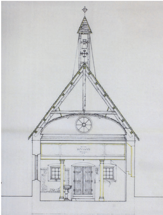
Una sezione della chiesa dove è visibile la cantoria conornata in giallo perché destinata ad essere demolita. Notare anche le centine di sostegno della volta dell'aula aggrappate all'orditura del tetto.
